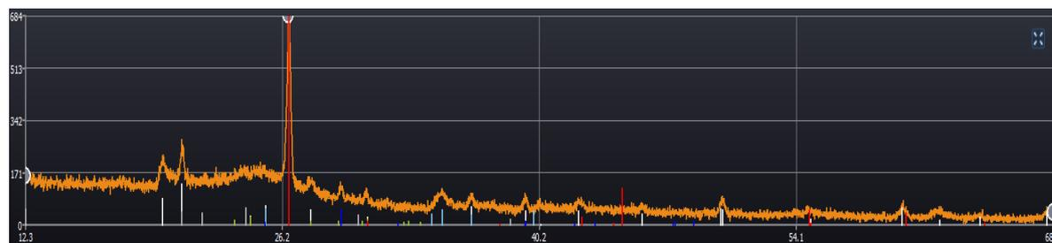
**Рисунок 4.** Дифрактограмма образцов почв Барзасского отвала
