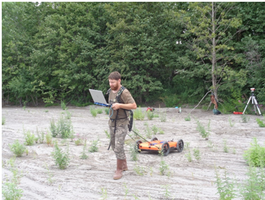
Рис. 1. Профилирование участка речной поймы георадаром ОКО-2 Fig. 1. Profiling of the river floodplain site by the georadar OKO-2
