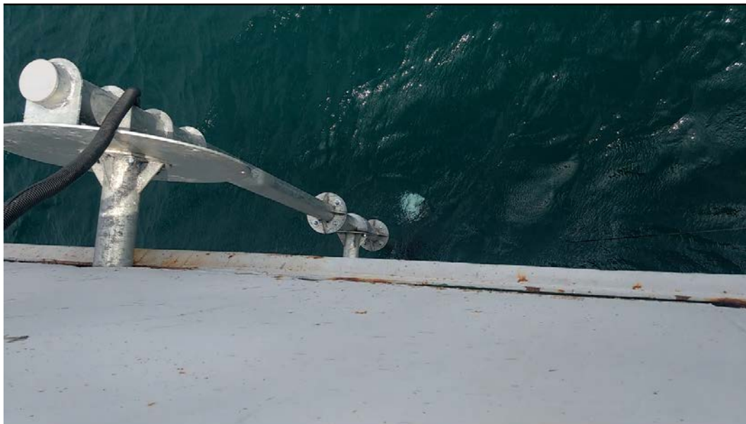
Рис. 2. Штанга забортного устройства с многолучевым эхолотом в рабочем положении
