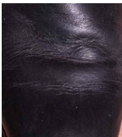
Рисунок 3. Влияние двукратной ННТП обработки на устойчивость верха обуви в период опытной эксплуатации: а – контрольный образец; б – опытный образец
